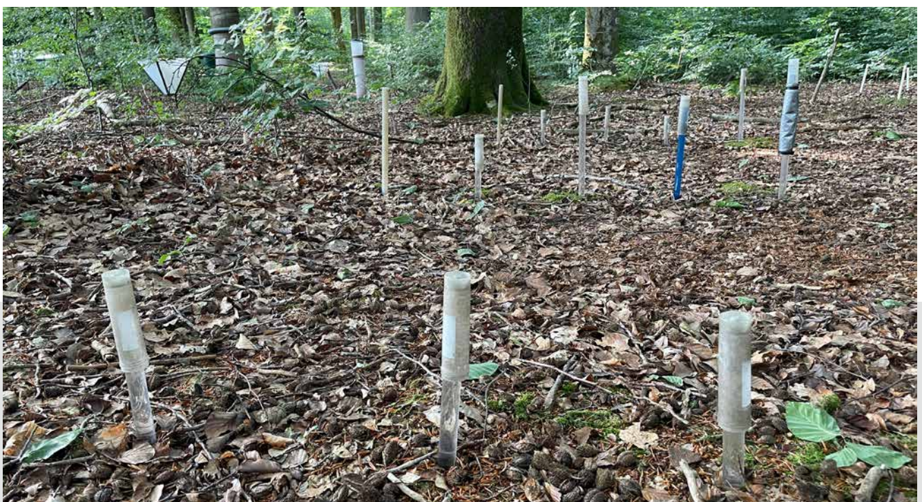
Messung der Bodenwasserspannung mit Tensiometern auf der Level-II-Fläche Haard
