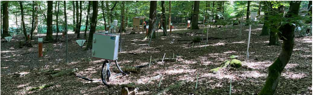
Bodenfeuchtemessstation auf der Level-II-Fläche Wipperfürth
