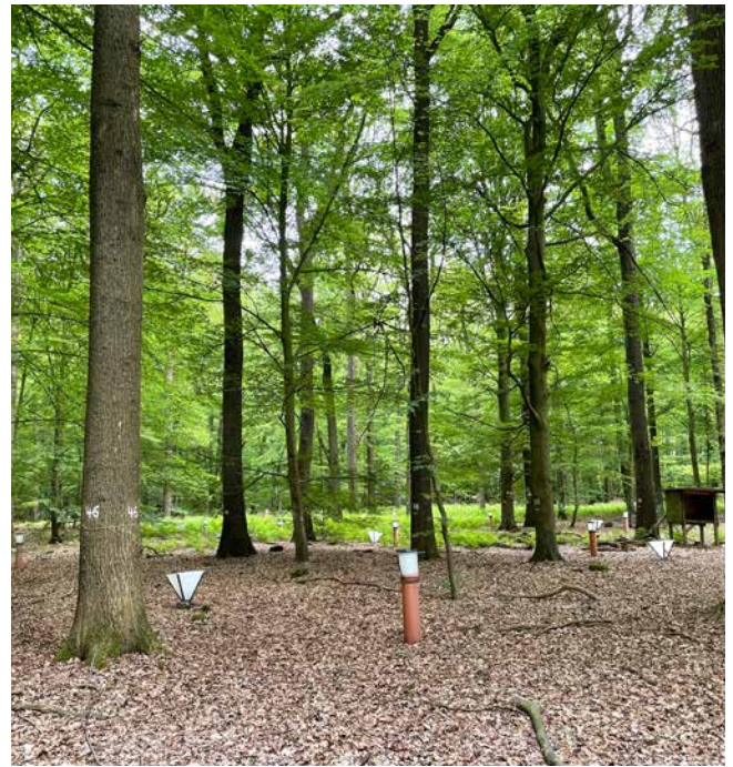
Depositions- und Streufallmessungen auf der Level-II-Fläche Tannenbusch/Kleve
