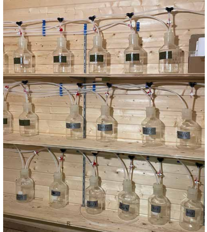
Messung von Sickerwasser auf der Level-II-Fläche Wipperfürth
