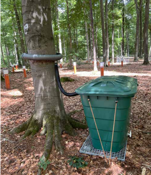
Stammabflussmessung auf der Level-II-Fläche Rott/Eifel
