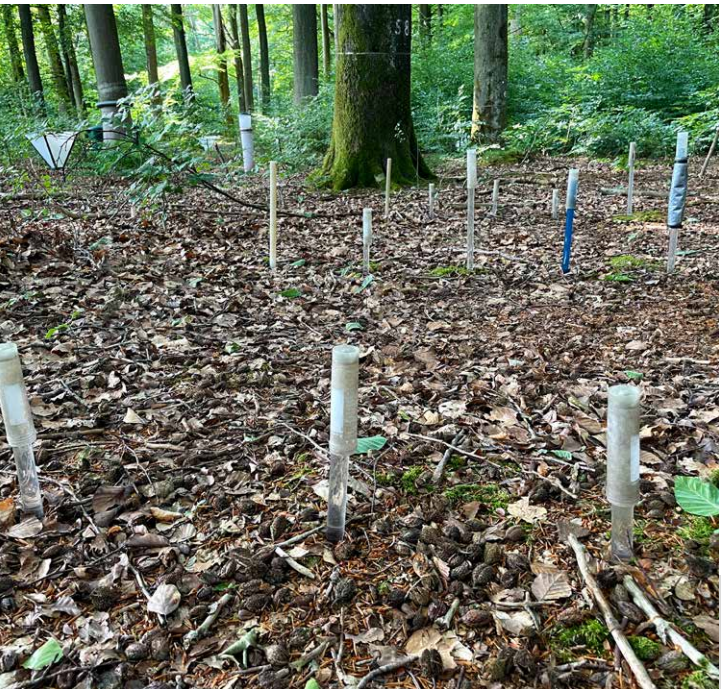
Messung der Bodenwasserspannung mit Tensiometern auf der Level-II-Fläche Haard
