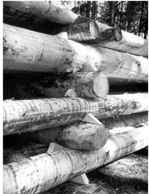
Abb. 1.: Sicherung der Stämme mit Holzkeilen.
