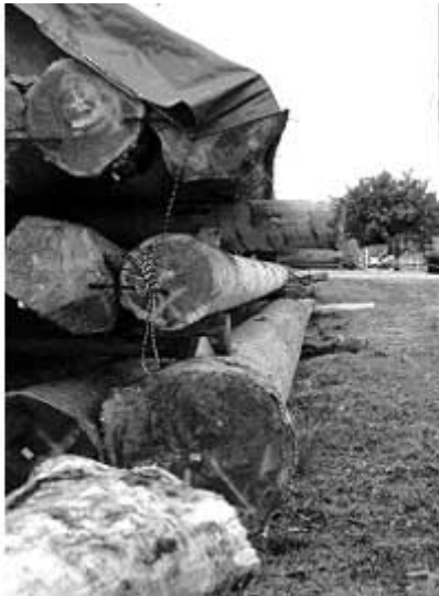
Abb.2: Falsch! Besser mit Überstand der oberen Reihe. Abb. 3: Richtig!
