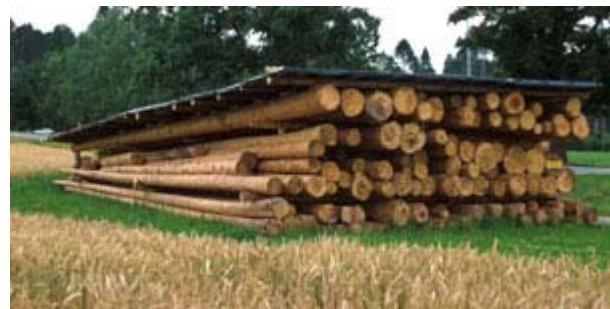
Überdachtes Trockenlager an luftiger Stelle.
